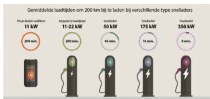
Figuur 1 Laders met verschillende vermogens en indicatieve laadtijden om 200 km bij te laden.
